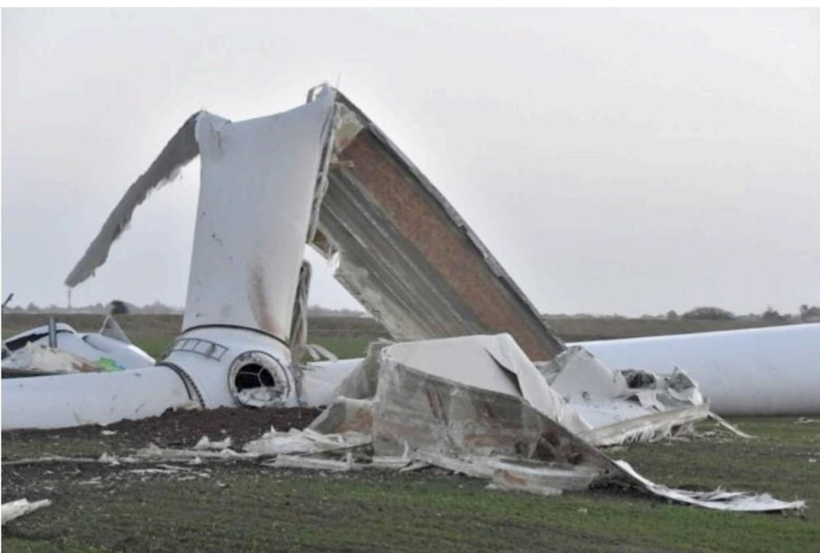
Überreste einer eingestürzten Windkraftanlage in Bouin, Frankreich. Sturm „Carmen“ hatte die Anlage am Neujahrstag 2018 wenige Meter neben einer Straße zu Fall gebracht. Deutlich erkennbar sind die verarbeiteten und durch den Unfall freigesetzten Fasern. Foto: Loic Venance/AFP via Getty Images
