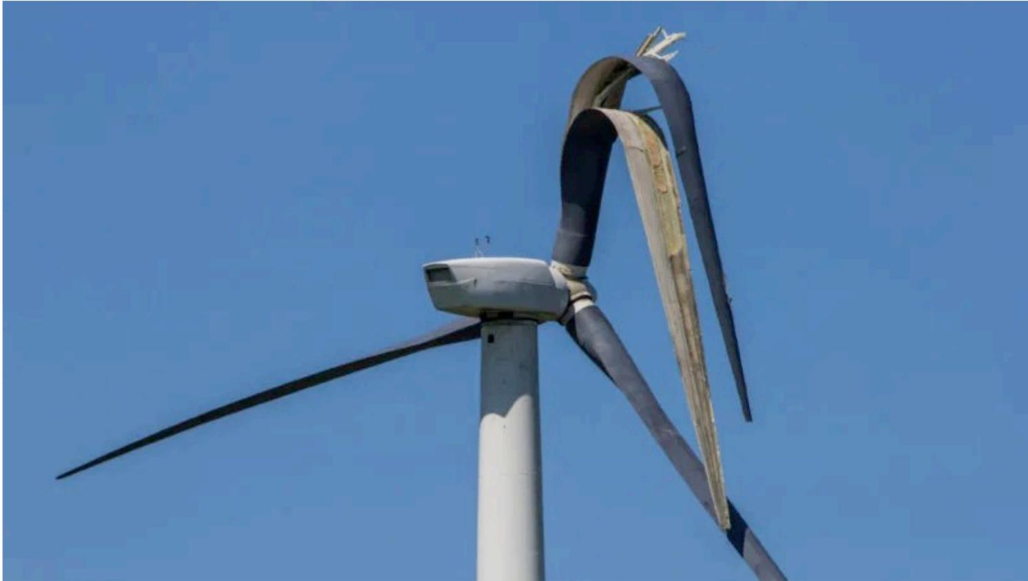
Stark beschädigter Windradmügel nach einem Blitzschlag.
