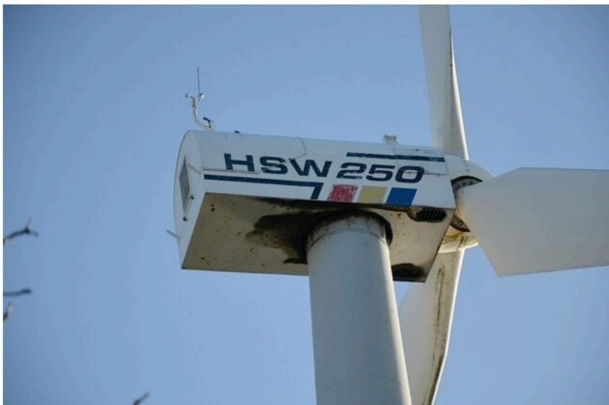
Deutliche Ölflecken zeichnen sich am Maschinenhaus einer Windkraftanlage im Windpark Burg auf Fehmarn ab.
